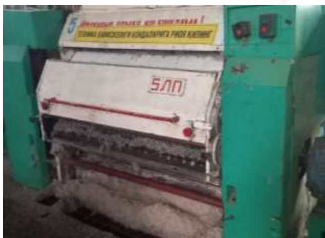
3-rasm: Paxta tozalash korxonalarida linter mashinalari batareyasida purkovchi BII-8 ventilyatorlarini qo'llanilmagan xolatida linter mashinalarining tag qismiga momiqni to'kilib qolish xolatlari
