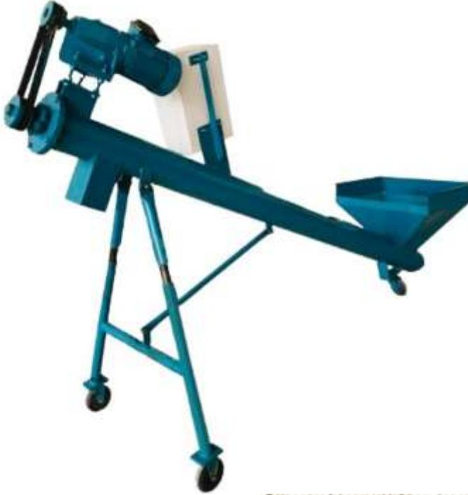
**Рис. 1. Общий вид малогабаритного дозирующего-загрузочного устройства.**
