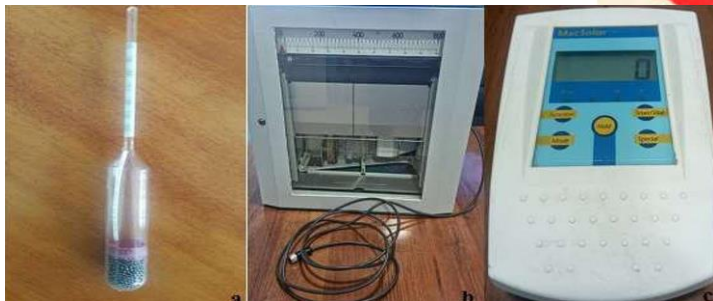
1-rasm. O'lchash uchun ishlatilgan asboblari. a) tuz konsentratsiyasini o'lchagich (areometr), b) harorat o'lchagich (KSP-4), c) quyosh energiyasini o'lchagich (aktinometr)
